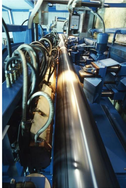
Les tubes d'acier seront fabriqués dans les installations de Corinth Pipeworks et comprendront un revêtement externe en polyéthylène de trois couches et un revêtement interne en époxy, appliqués au même endroit que la fabrication des tubes, dans l'usine de Thisvi, en Grèce.
