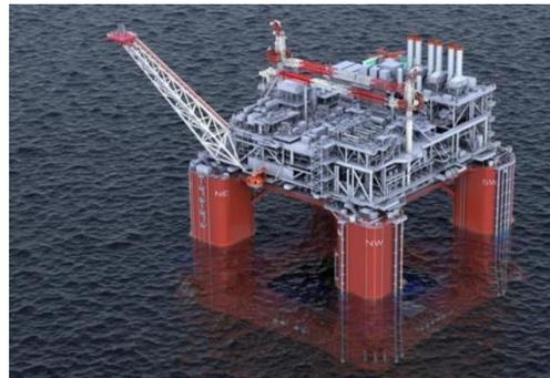
Le développement comprend un système sous-marin à arbre humide connecté à une unité de production flottante (FPU), qui sera reliée à une unité de stockage et de déchargement flottante (FSO), garantissant une extraction et un traitement efficaces des ressources.
